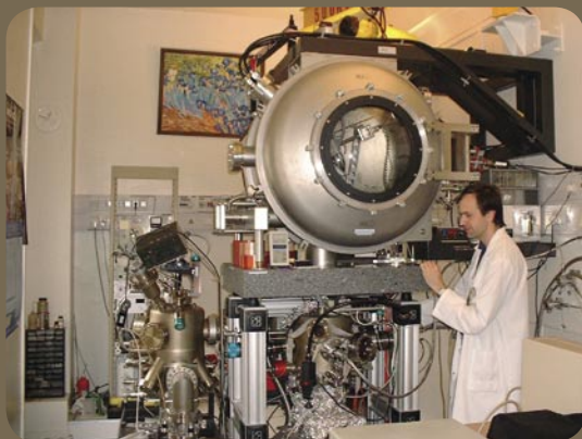
IRIS analyse les rayons X émis par les éléments présents à des interfaces, lieux de contact entre deux solides. Cette analyse permet de comprendre les propriétés des matériaux multicouches.
